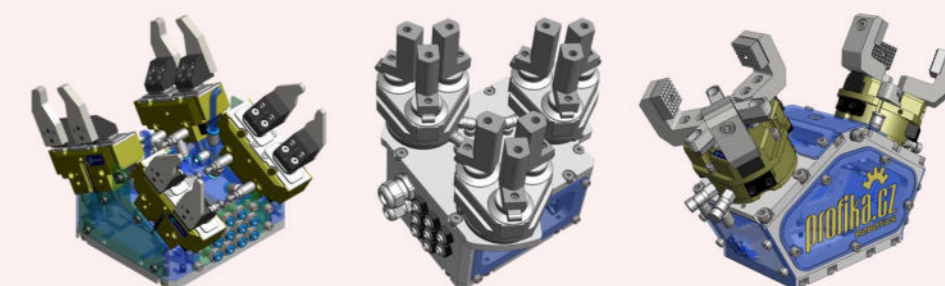
Zobrazení, na míru navržených, koncových efektorů robota pro robotické buňky RoboStack a RoboStack Linear
